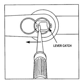
FIG. 23: REMOVING THE IC CORE LEVER
