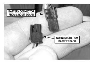
FIG. 17: CONNECT THE BATTERY PACK
