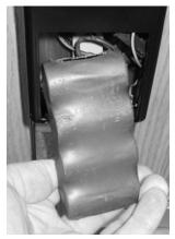
FIG. 18: INSERT BATTERY PACK INTO HOUSING
